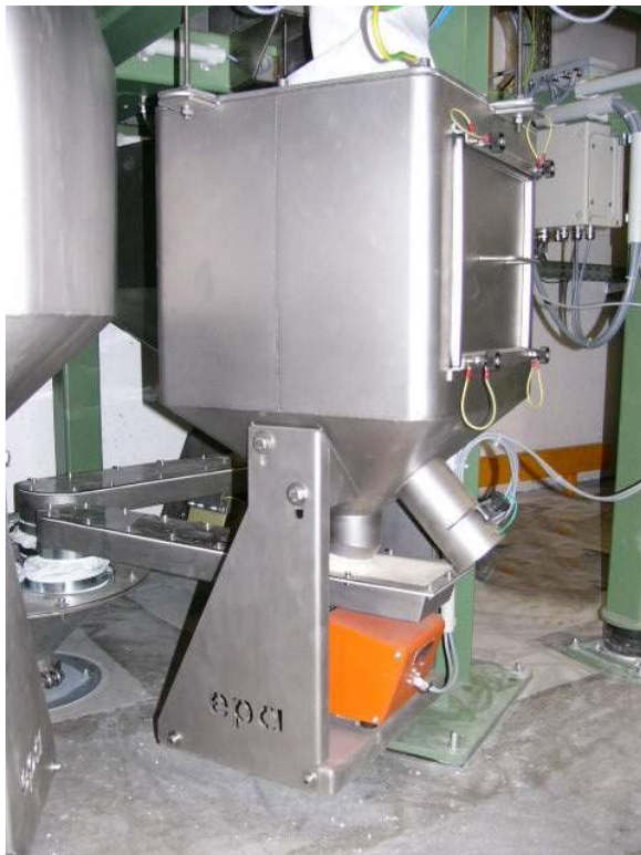
Dosieranlage für 4 Komponenten mit Nachfüll-Förderanlage Dosiergerätebehälter mit Schnellentleerung und Reinigungsklappen Dosierleistung der einzelnen Geräte 2 – 1000kg/h
