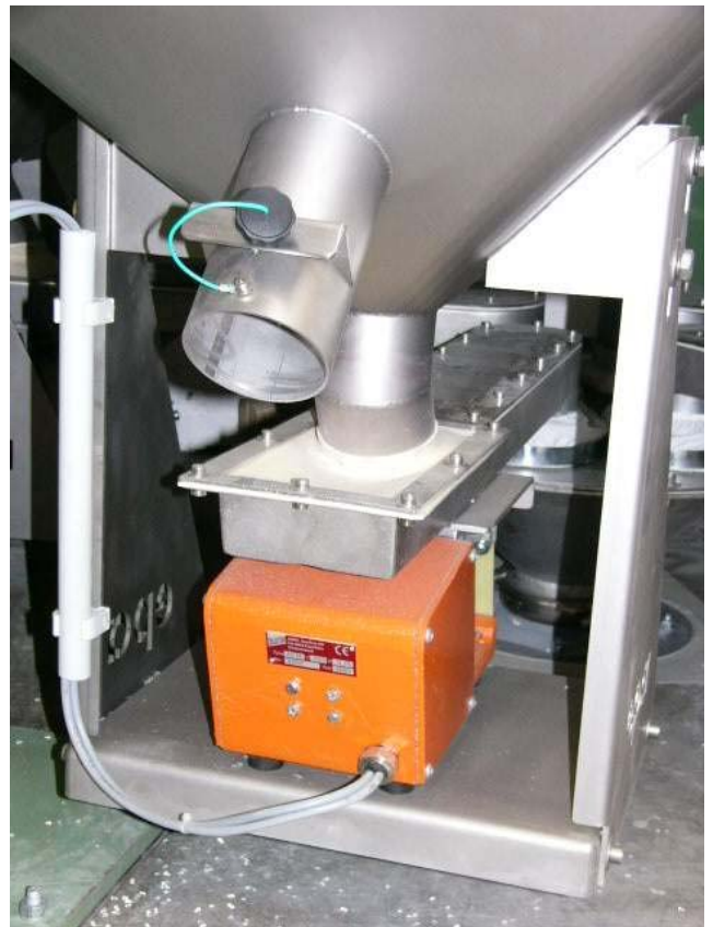
Dosieranlage für 4 Komponenten mit Nachfüll-Förderanlage Dosiergerätebehälter mit Schnellentleerung und Reinigungsklappen Dosierleistung der einzelnen Geräte 2 – 1000kg/h
